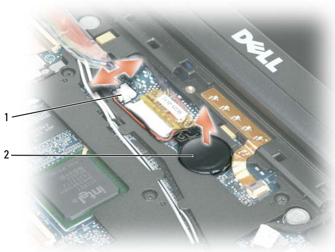
1 connettore del cavo 2 batteria pulsante
